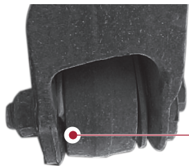
Falta la brida de hule
