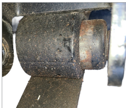
◀ Desplazamiento del buje en AIRTEK NXT
